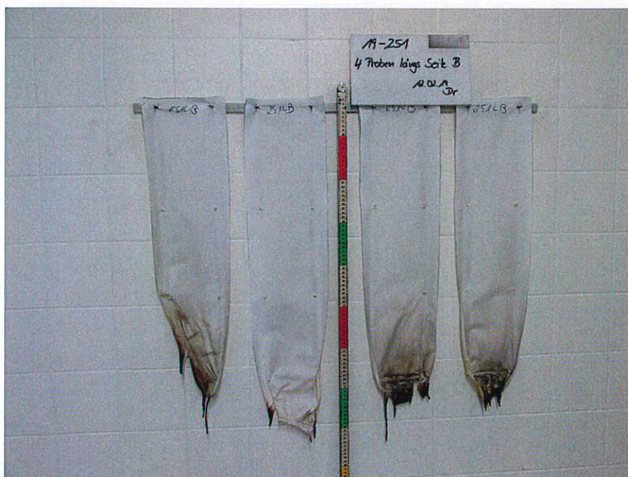
Bild 2: Aussehen der Proben nach dem Brandversuch
